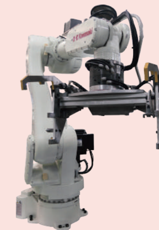
ハンド治具(ATC)、定置スポット溶接機 ナットフィーダー
