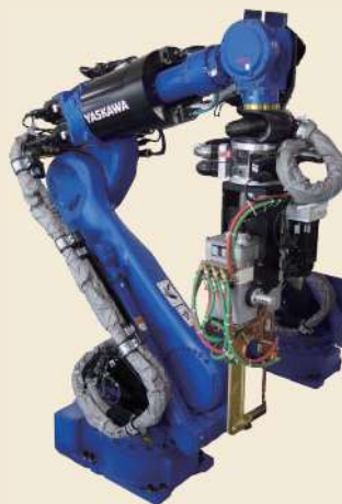
スポット溶接、ATCガン(X、C) 外部軸治具回転
